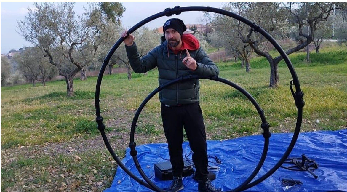
Bobina di ricerca da 1 metro di diametro e da 2 metri di diametro
